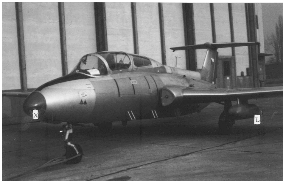
Obr. 7.7.4 Letadlo L-29 – Delfín: X – xenonové výbojky, L – laserové odrážecí
